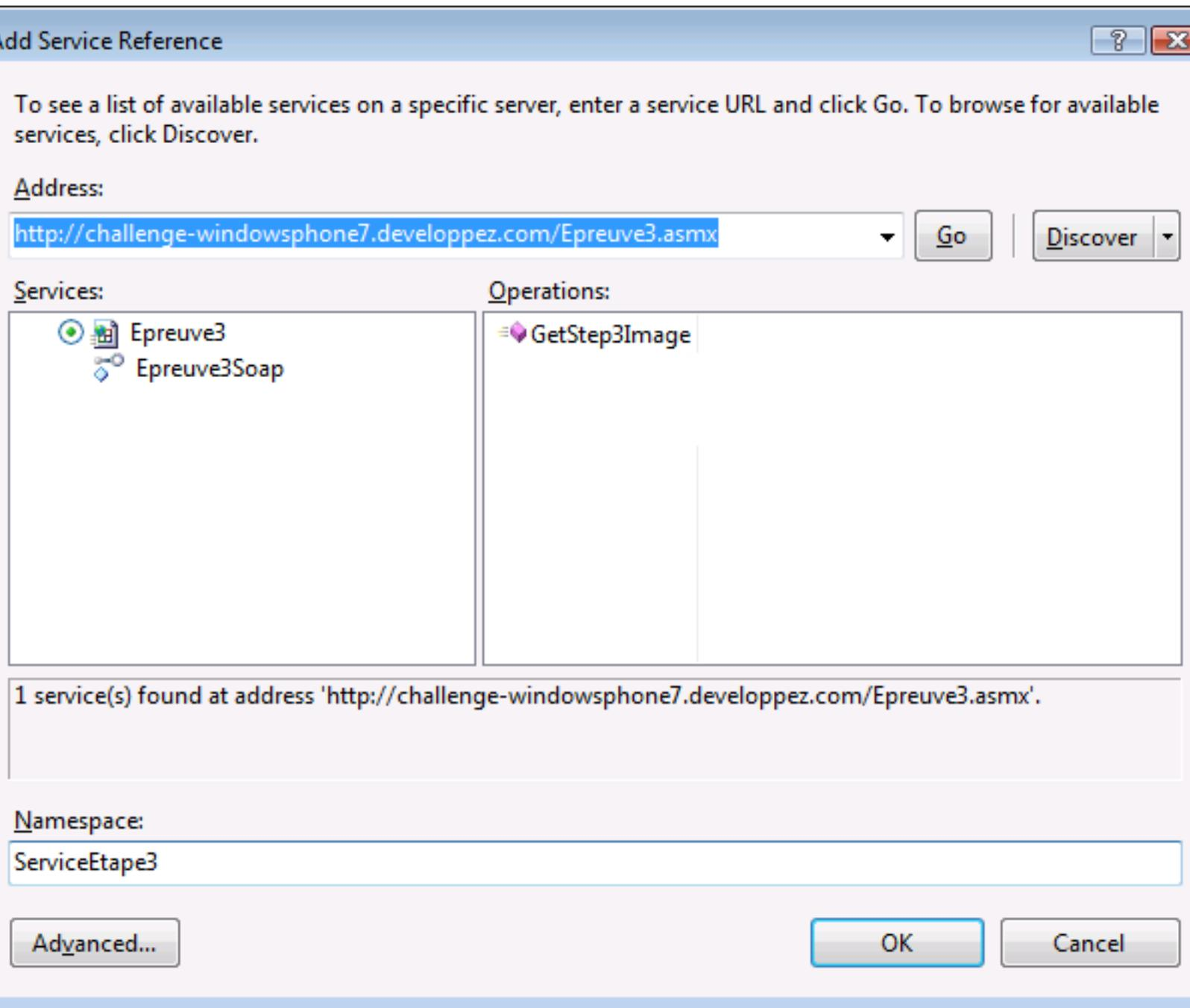
La méthode `GetStep3Image` permet, en lui passant un entier, de télécharger l'image correspondant à ce numéro d'index sous forme d'un tableau de bytes.
