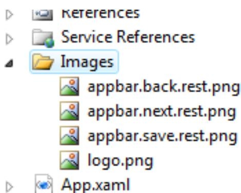
**!** Il faut absolument que ces images soient configurées avec Build Action = Content et Copy to Output Directory = Always, sinon, elles n'apparaîtront pas dans l'émulateur
